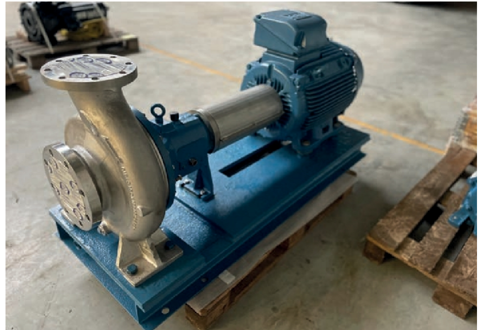
Une combinaison de moteurs de pompe a été révisée par Pump Fleet Services, qui fait partie de The Rotating Company. (©The Rotating Company)
