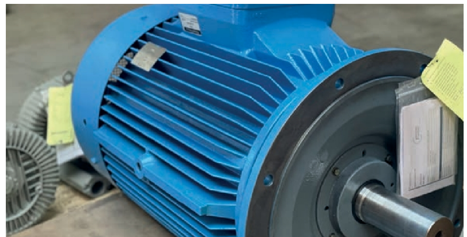
Un moteur de pompe à bride reconditionné par The Rotating Company. (©The Rotating Company)
